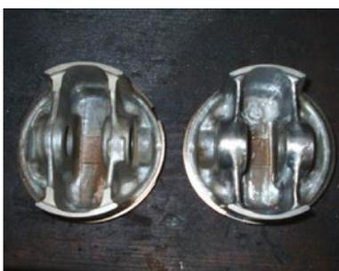
Hier werden von uns Kolben und Pleuel mit hochfiligranen Schleifgeräten aus der Zahnmedizin bearbeitet und überschüssiges Gewicht, wie Grate und Ähnliches entfernt. Des Weiteren werden die Bauteile auf das Milligramm ausgewogen und angepasst. Auch hier haben wir Differenzen in den Gewichten von mehr als 8 Gramm feststellen müssen. Da wundert es einen kaum, dass einige BMW-Boxer richtig bockig laufen.
