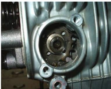
Bei diesem Arbeitsschritt überprüfen wir die Steuerzeiten Ihres Boxers. Da die Nockenwellen über Ketten und Zahnräder angetrieben werden, mussten wir feststellen, dass vom Werk aus Abweichungen von mehr als sechs Grad vorlagen, wodurch eine Boxermotor gleich mal einige PS verlieren kann.
