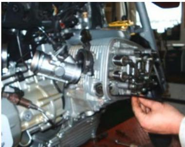
Einbau Zylinder mit neuer Fußdichtungsmasse. Zylinderkopfmontage Sämtliche Dichtungen oder O-Ringe werden von uns erneuert. Sämtliche Schrauben werden bei uns peinlichst genau mit Drehmoment laut Werksangaben festgezogen.
