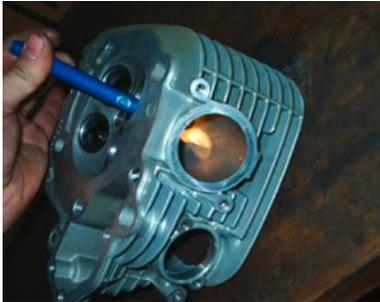
Das Bearbeiten der Ein- und Auslasskanäle verbessert die Strömungsgeschwindigkeit der Frischgase, was letztendlich zu einer Leistungssteigerung verhilft. Die Gewichtsreduzierung und Anpassung der Kipphebel verbessert den Motorlauf durch weniger bewegte Massen im Zylinderkopf.
