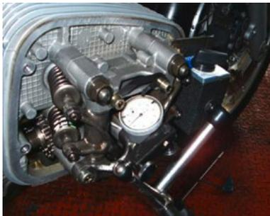
Mit Hilfe einer Gradscheibe auf der Kurbelwelle und einer Messuhr, welche am Kolbenboden aufsitzt wird der genaue OT – Punkt beider Zylinder ermittelt. Dies ist eine Grundlage für alle weiteren Tuningmaßnahmen wie Brennraumauslitern oder Steuerzeitenfeineinstellung.
