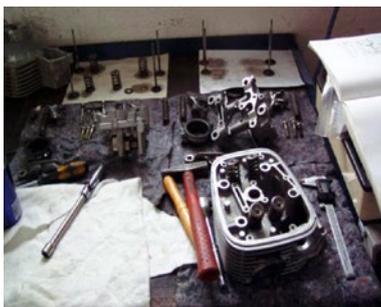
Zunächst werden alle tuningrelevanten Bauteile, wie Köpfe, Zylinder, Kolben und Pleuel demontiert. Anschließend werden alle Bauteile auf Verschleiß (im speziellen die Pleuellager), auf Beschädigungen und exakte Funktion überprüft und gereinigt (entfernen von Brennkohle und Ähnlichem)!
