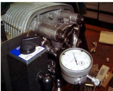
Mit Messuhren und Gradscheibe stellen wir die Steuerzeiten von Einlassventil und Auslassventil exakt auf die BMW-Werksangaben ein. Durch Verdrehen der Nockenwellenräder haben wir die Toleranzen ausgeglichen und dadurch dem Boxermotor zur höheren legalen Leistung und besseren Gasannahme verholfen. Jetzt machen weitere Tunings Sinn.
